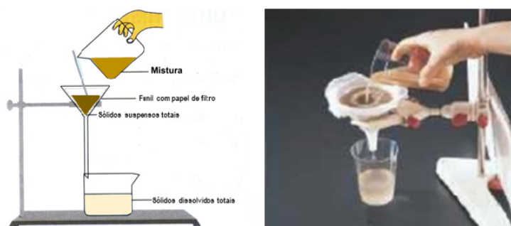
Figura 80 - Filtragem de uma amostra de água (sólidos suspensos e dissolvidos).
